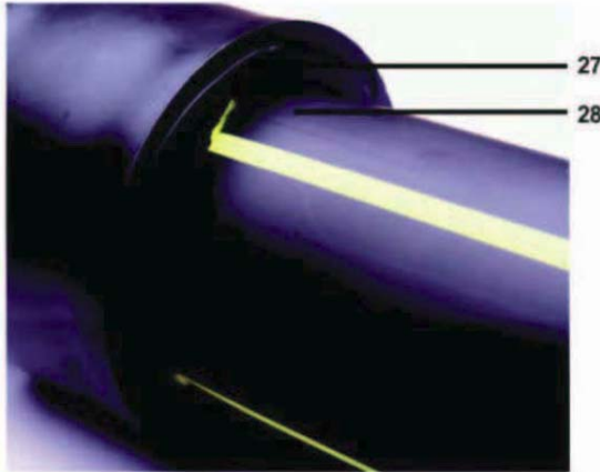
27. Cordón (labios) derretido aplanado por el anillo frío 28. Sin huecos o vacíos
