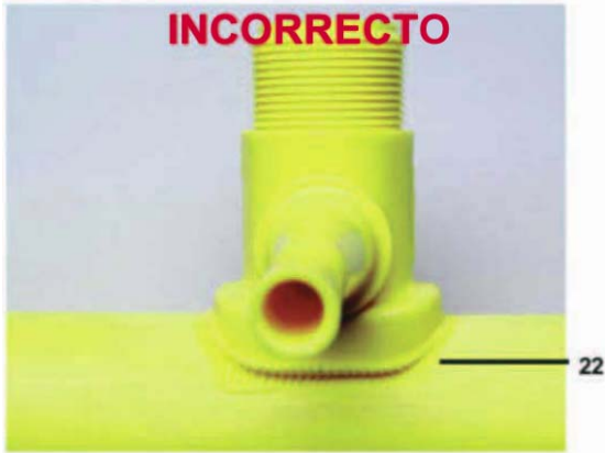
22. Fusión insuficiente y desalineación
