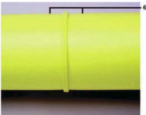
5. Doble cordón (labios) enrollado correcto 6. Correcta alineación
