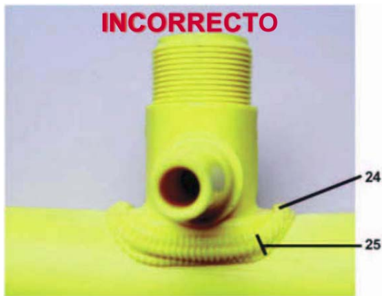
24. Cordón (labios) por arriba de la base del accesorio 25. Exceso de fusión y fuerza
