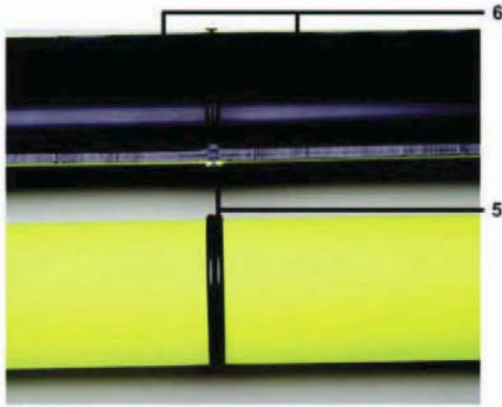
5. Doble cordón (labios) enrollado correcto 6. Correcta alineación
