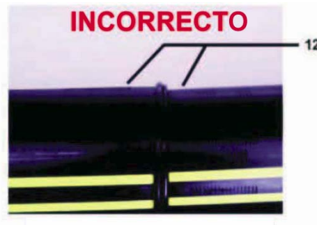
10. Exceso de tiempo de calentamiento o exceso de presión aplicada durante el calentamiento; cordón (labios) de fusión muy grande
