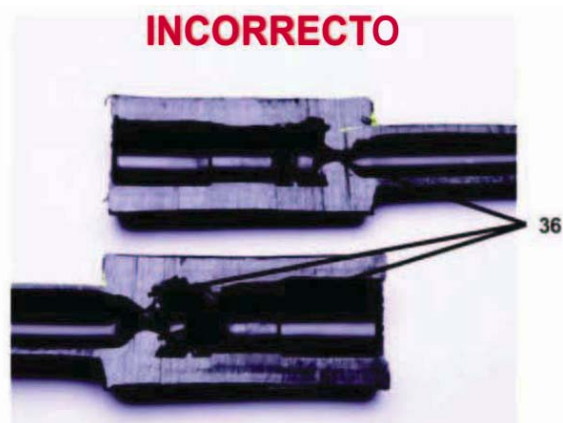
36. Exceso de calentamiento
