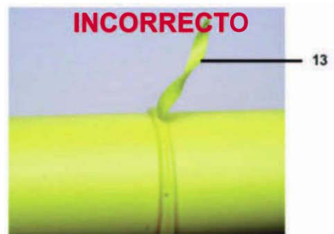
13. Empate incompleto o no remoción de tiras empataadas (viruta)
