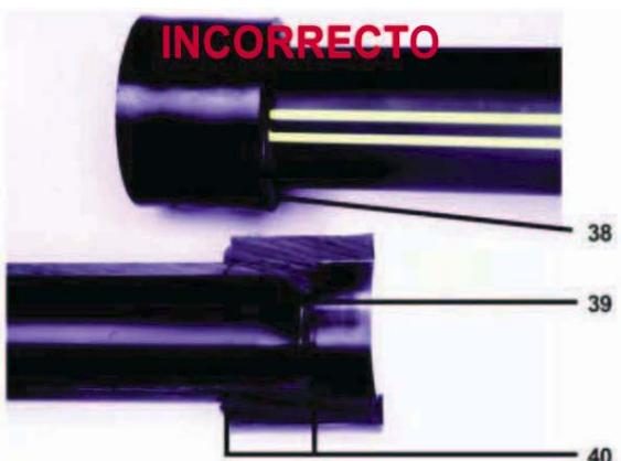
38. El cordón (labios) derretido no se aplastó contra el accesorio o el anillo frío
