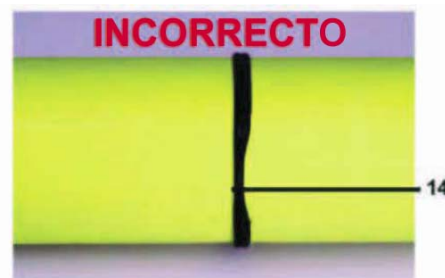
12. Inadecuada alineación "Arriba - Abajo"
